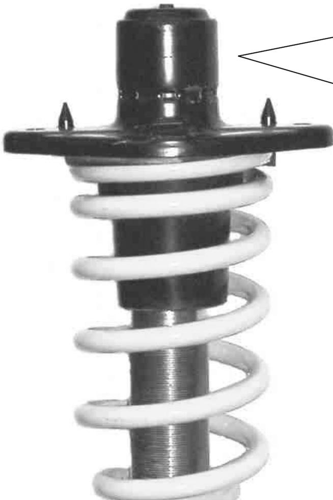
Komplett montiertes HA-Federbein. Das Anzugsdrehmoment der Kolbenstangenbefestigung beträgt 25 Nm. Die Montagehinweise zum Einbau des Federbeines in das Fahrzeug, sowie die Anzugsdrehmomente der Federbeinbefestigung, entnehmen Sie bitte den Unterlagen des Fahrzeugherstellers.
