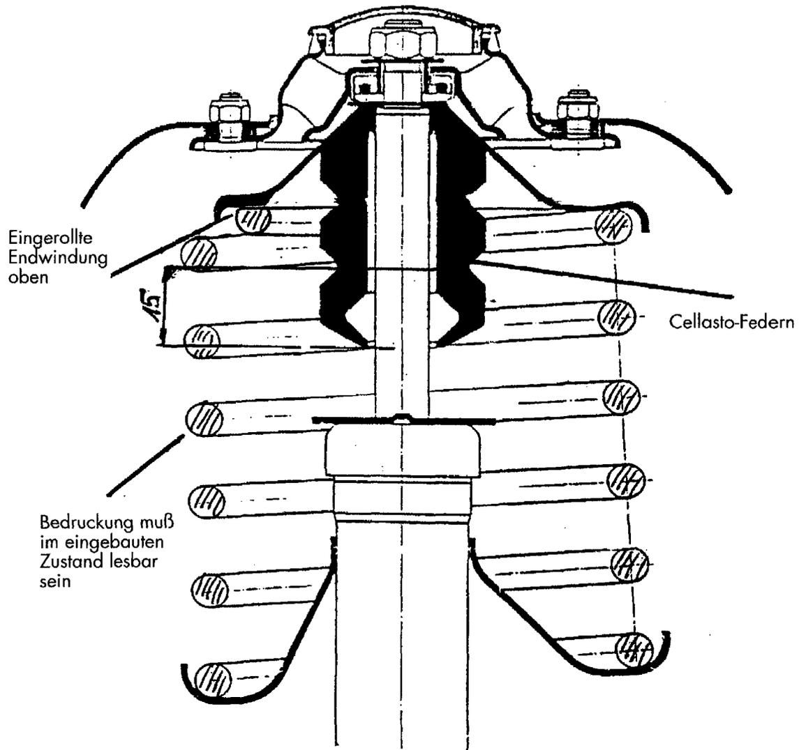
Bei dem Fahrwerksumbau auf den E & W-Kit 82 42.1.40 muß die Cellasto-Feder an der Vorderachse am unteren Ende um 15 mm gekürzt werden (siehe Bild).
